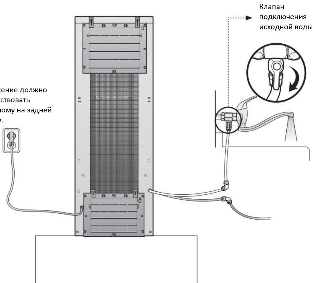
Подсоедините оранжевую трубку 1 к источнику исходной воды и синюю трубку 2 к линии дренажа.
