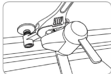
2. Намотайте фум-ленту на адаптер и подключите его к трубе водоснабжения.
