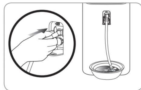
3. Сначала снимите верхнюю крышку системы, затем отсоедините клипсы держащие крышку накопительной емкости. После этого отсоедините трубку и снимите крышку накопительной емкости.
