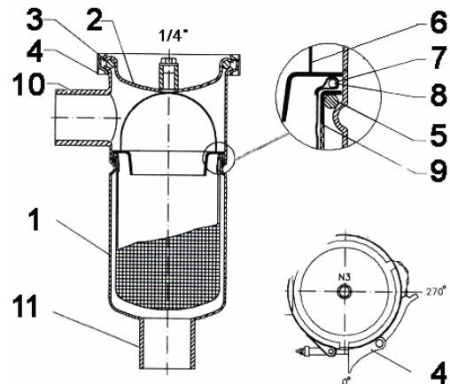
Во время работы фильтра вода поступает через входной патрубок 10 и, проходя через фильтрующий элемент, очищается от мельчайших примесей. Отфильтрованная вода выводится вниз через выходной 11 патрубок.
