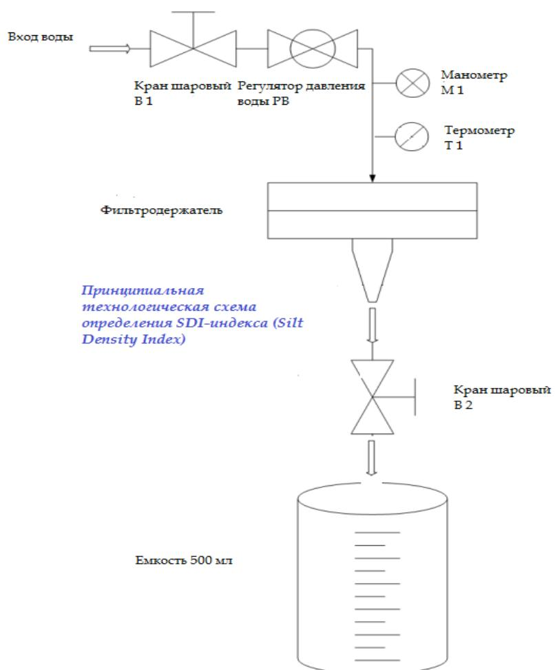
11. Закройте входной вентиль В-1 и сбросьте давление с измерительного модуля, открыв для этого вентиль В-2. После чего вентиль В-2 закройте.
